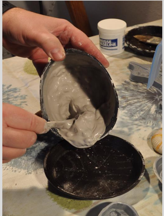
Abb. 6: Angerührten Gips in die Gießform füllen
